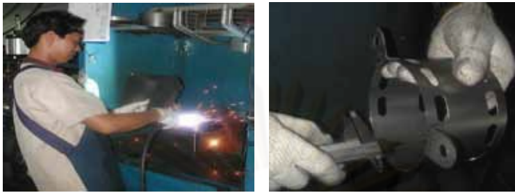
รูปที่ 4.12 การเชื่อมเพลท/หู
