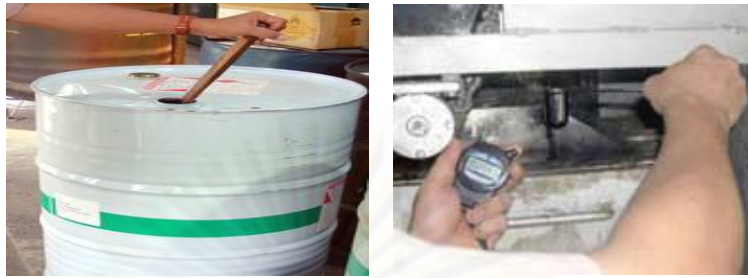
รูปที่ 4.48 การผสมวานิชพร้อมวัดความเหนียว
