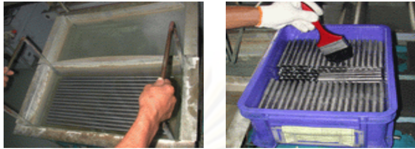
รูปที่ 4.28 การชุบเคลือบชิ้นงานแะทาน้ำมัน
