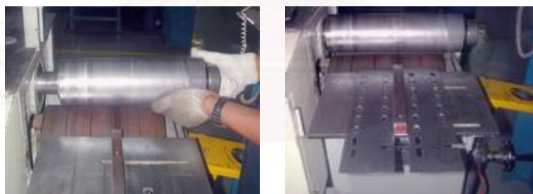
รูปที่ 4.1 การประกอบลูกกลิ้งและใส่แผ่นเหล็ก
