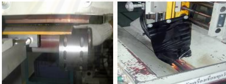
รูปที่ 4.3 การใส่ชิ้นงานและเชื่อม
