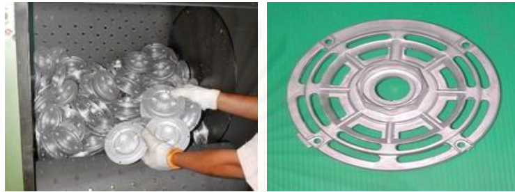
รูปที่ 4.54 การตรวจสอบฝาลอคูมึเนียม
