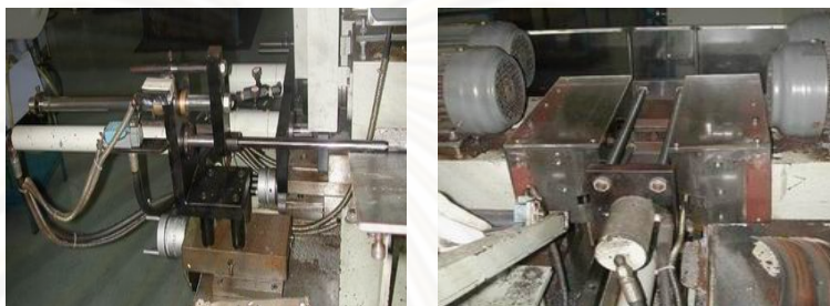
รูปที่ 4.15 การใส่แกนเข้าเครื่อง
