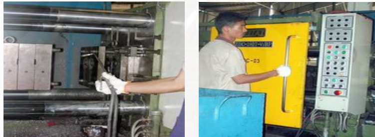
รูปที่ 4.55 การตั้งเครื่องฉีดโรเตอร์
