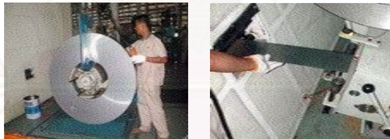
รูปที่ 4.63 การใส่แผ่นเหล็กเข้าเครื่องป้อน
