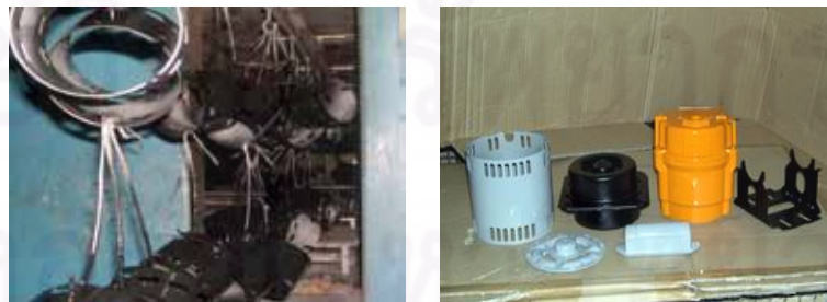
รูปที่ 4.77 การอบชิ้นงาน
