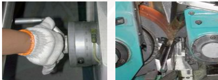
รูปที่ 4.13 การตั้งค่าและใส่ชิ้นงาน
