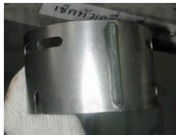
รูปที่ 4.4 เปลือกที่เชื่อมเสร็จแล้ว
