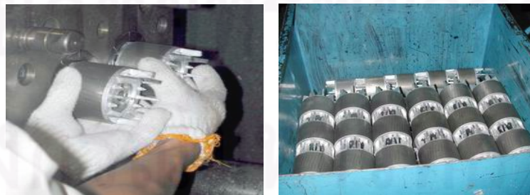
รูปที่ 4.56 การฉีดโรเตอร์
