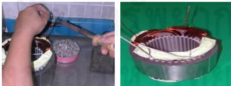
รูปที่ 4.45 การบัดกรีลวดทองแดง
