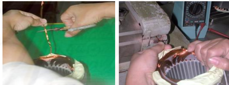
รูปที่ 4.44 การตัดปลายและขัดลวดทองแดง
