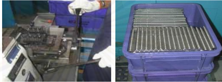
รูปที่ 4.20 การปาดชิ้นงาน
