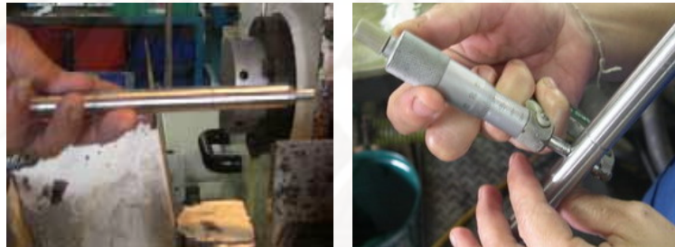
รูปที่ 4.34 การเจียรปลายและตรวจสอบ
