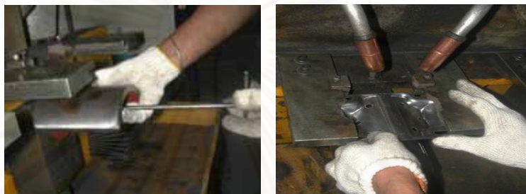
รูปที่ 4.5 การใส่ชิ้นงานที่จะเชื่อม
