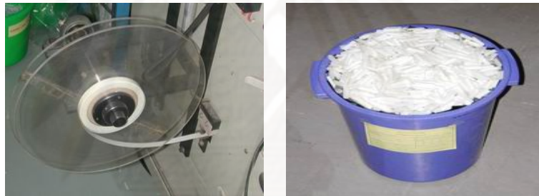
รูปที่ 4.73 การตัดไมล้า
