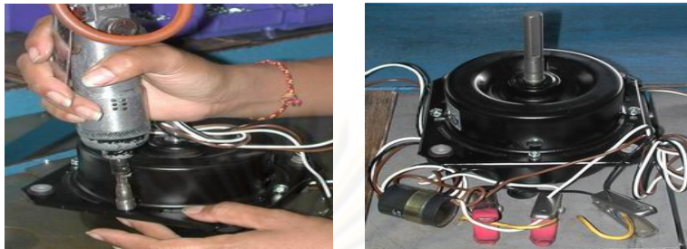
รูปที่ 4.80 การประกอบฝาหน้าหลัง
