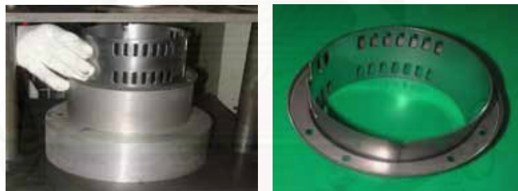
รูปที่ 4.11 การใส่ชิ้นงานและอัด
