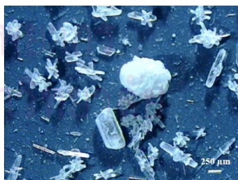
รูปที่ 4.7 การเกาะและโตของผลึก MAP (Regy และคณะ, 2002) ที่กำลังขยายภาพ 10 เท่า
