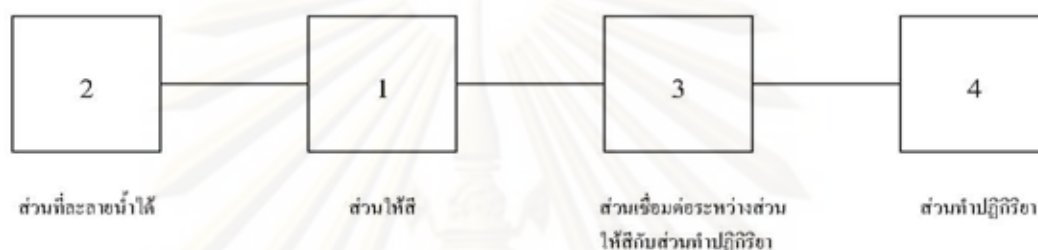
แผนภาพที่ 2.2 องค์ประกอบหลักของโครงสร้างสีรีแอกทีฟ
