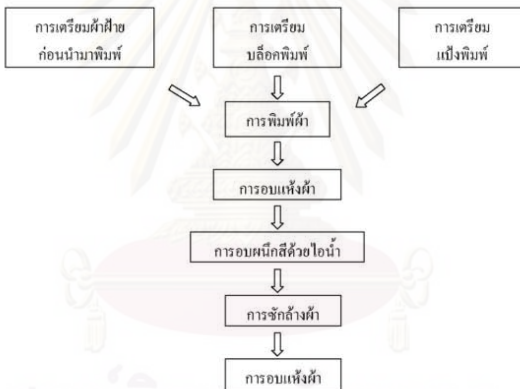
แผนภาพที่ 3.1 ขั้นตอนการพิมพ์ผ้าฝ้ายด้วยสีรีแอกทีฟ
