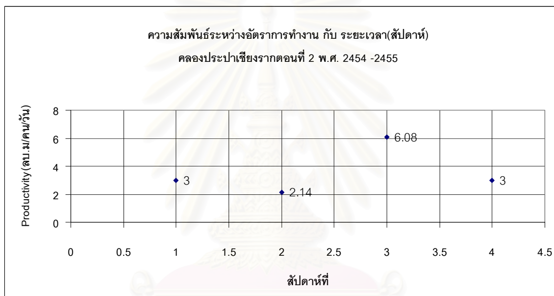
รูปที่ 5.5 กราฟแสดงความสัมพันธ์ระหว่างอัตราการทำงาน กับระยะเวลา(สัปดาห์)ของการขุดคลองประปาเชียงราก ตอนที่ 2
