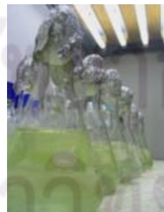
รูปที่ 3.1 ระบบเพาะเลี้ยงสาหร่ายในห้องปฏิบัติการ
