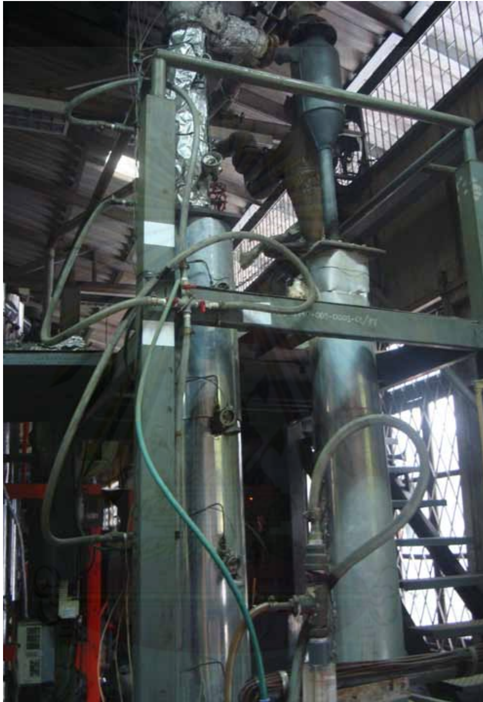
รูปที่ 3.2 เตาเผาฟลูอิไดซ์เบดแบบหมุนเวียนที่ใช้ในงานวิจัย
