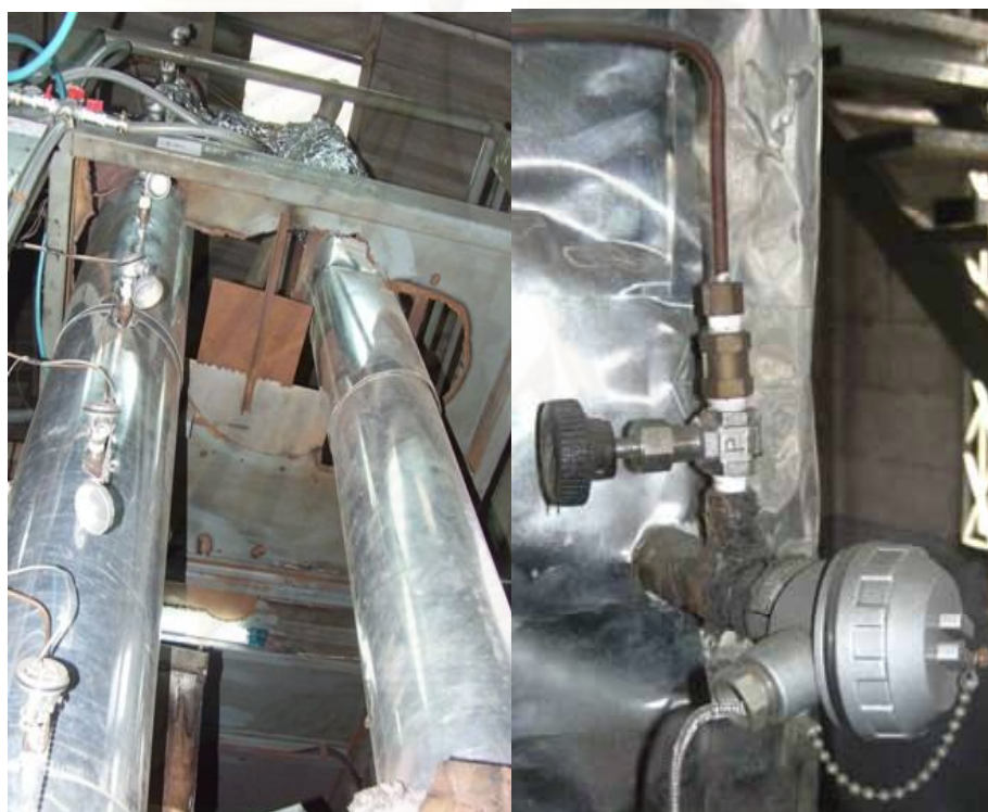
รูปที่ 3.14 probe สำหรับวัดอุณหภูมิและองค์ประกอบของแก๊ส
