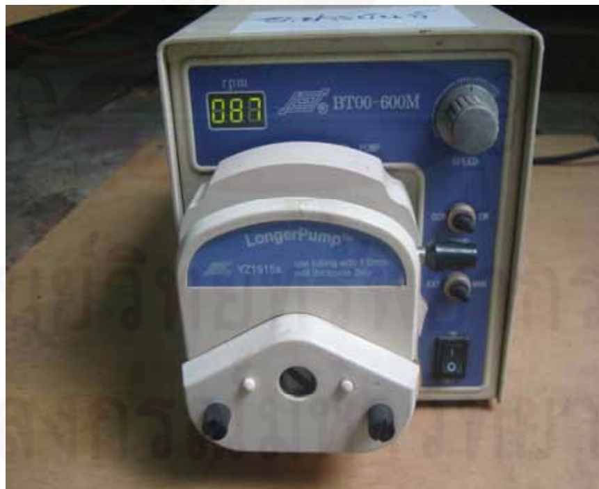
รูปที่ 3.16 ปั๊มดูดจ่ายของไหล (peristaltic pump)
