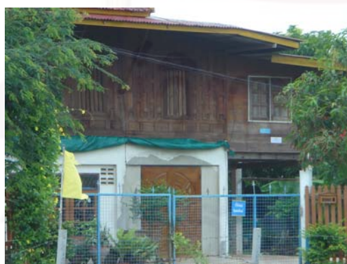
ภาพที่ 3.21 วัสดุที่ใช้ในการก่อสร้างสถาปัตยกรรม: การใช้ทั้งไม้จริงร่วมกับการก่ออิฐฉาบปูนเป็นวัสดุหลักที่ใช้ในการก่อสร้างตัวอาคารพักอาศัย
