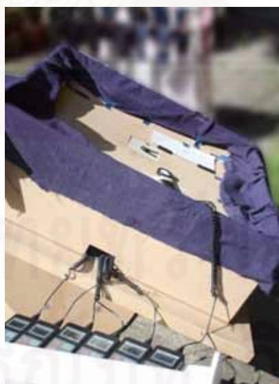
รูปที่ 3.18 แสดงลักษณะการติดตั้งเครื่องมือวัดแสงกับหุ่นจำลอง
