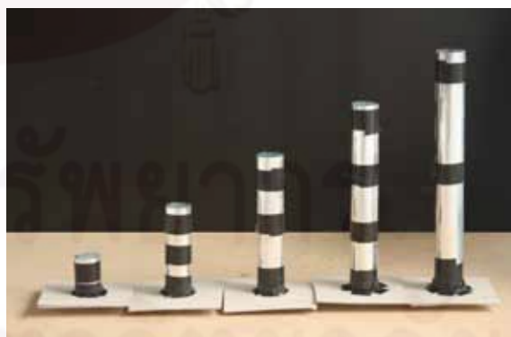
รูปที่ 3.14 แสดงลักษณะของท่อนำแสงแนวตั้งขนาดเส้นผ่านศูนย์กลาง 0.60 เมตร. ในมาตราส่วน 1:20
