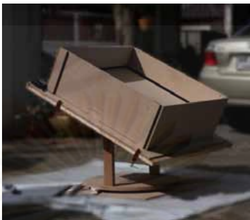
รูปที่ 3.4 แสดงลักษณะหุ่นจำลองเมื่อบางบนเครื่องมือHeliodon
