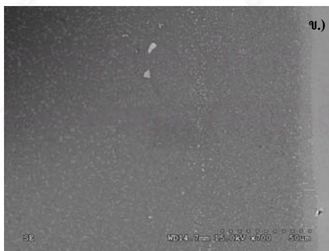
รูปที่ 4.31 ภาพถ่ายโครงสร้างโลหะผสมพิเศษเนื้อพื้นนิกเกิลชนิด GTD 111 ที่เคลือบผิว 900^{\circ}\text{C} เป็นเวลา 4 ชั่วโมง แล้วทำการอบเป็นเนื้อเดียวเป็นเวลา ก.) 6 และ ข.) 10 ชั่วโมง ด้วยกล้อง SEM
