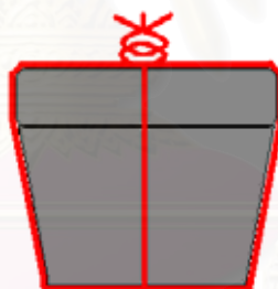
รูปที่ 3.1 แสดงลักษณะการพันลวดสแตนเลสรอบถ้วยอะลูมินา
