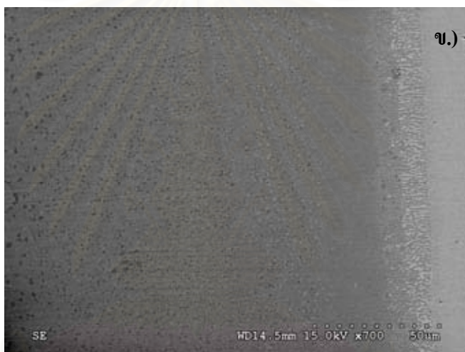
รูปที่ 4.29 ภาพถ่ายโครงสร้างโลหะผสมพิเศษเนื้อพื้นนิกเกิลชนิด IN 738 ที่เคลือบผิว 900 °C เป็นเวลา 4 ชั่วโมง แล้วทำการอบเป็นเนื้อเดียวเป็นเวลา ก.) 10 และ ข.) 20 ชั่วโมง ด้วยกล้อง SEM
