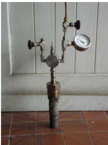
รูปที่ 3.8 เครื่องปฏิกรณ์ขนาดเล็ก ปริมาตร 70 ลิตร ทนความร้อนได้ถึง 500 องศาเซลเซียส ความดัน 10 เมกกะพาสแกล
