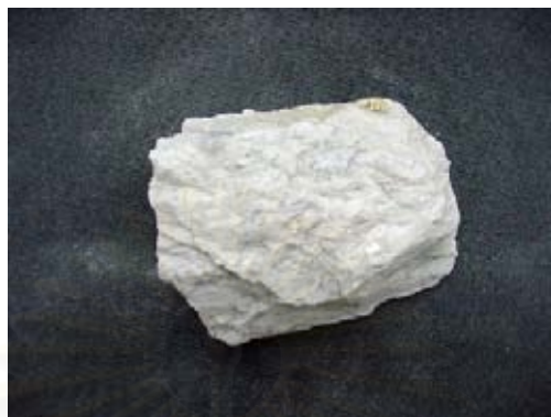
รูปที่ 2.2 ลักษณะของดินขาวที่มีสารประกอบของแคลเซียมคาร์บอเนต
