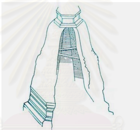
รูปที่ 5.29 การใช้ไม้ยันโครงสร้างเจดีย์วัดจنگกลม [64]
