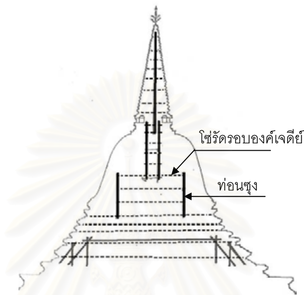
รูปที่ 5.40 การใช้ท่อนซุงเป็นแกนองค์เจดีย์และใช้โซ่รัดรอบองค์เจดีย์ [1]
