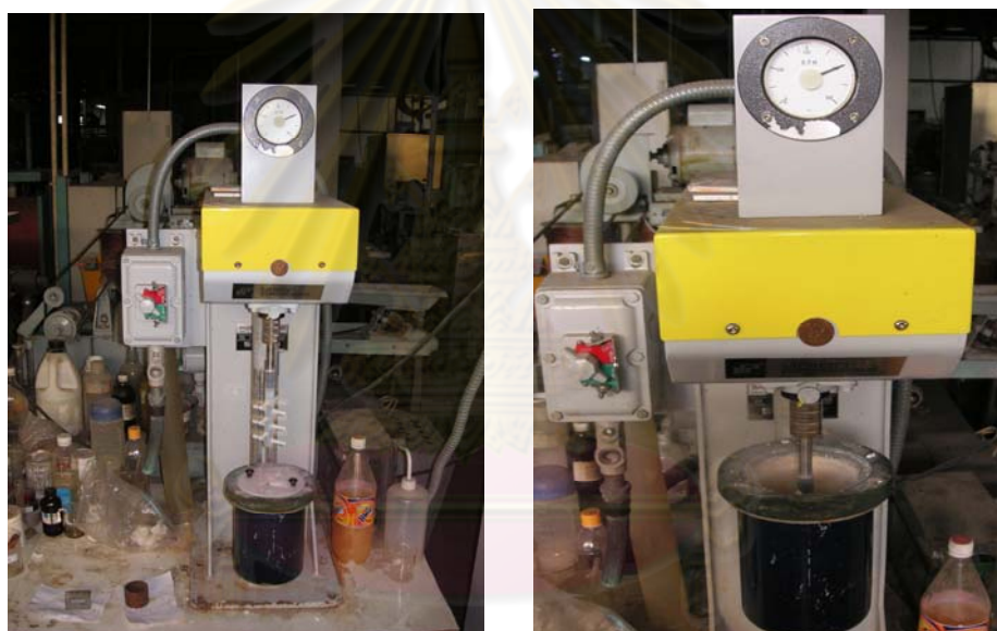
รูปที่ 4.5 เครื่องบดแอททริชันมิลล์ (Attrition Mill)
