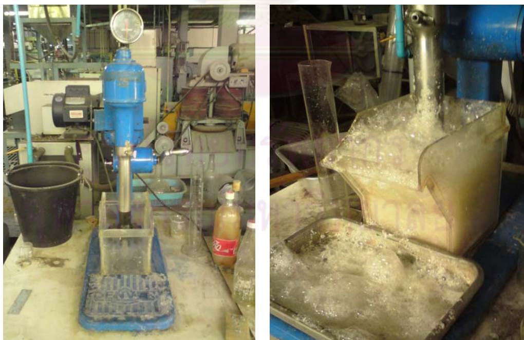
รูปที่ 3.4 แสดง Laboratory Flotation Cell เครื่องลอยแร่ที่ใช้ในการศึกษาวิจัยครั้งนี้
