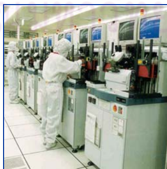
รูปที่ 3.15 การเชื่อมวงจรไฟฟ้าจาก Die เข้ากับ Lead Frame
