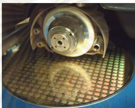
รูปที่ 3.11 การตัดแผ่น wafer
