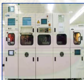
รูปที่ 3.17 เครื่องพิมพ์ตัวหนังสือลงบนตัว IC
