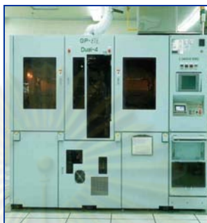
รูปที่ 3.16 เครื่องฉีดพลาสติก เพื่อเคลือบวงจรรวม
