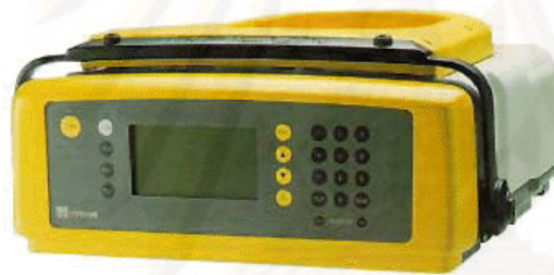
ภาพที่ 2.2 เครื่องมือตรวจสารไวไอซีชนิดแก๊สโครมาโตกราฟีแบบพกพาและวิธีการใช้
