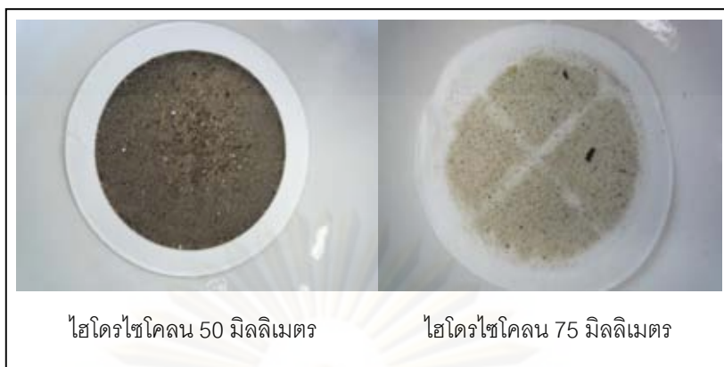
รูปที่ 4.8 เปรียบเทียบความเข้มข้นของของแข็งที่แยกได้ที่ทางออกด้านล่างระหว่างไฮโดรไซโคลนแบบธรรมดาขนาดเส้นผ่านศูนย์กลาง 50 มิลลิเมตรและไฮโดรไซโคลนแบบธรรมดาขนาดเส้นผ่านศูนย์กลาง 75 มิลลิเมตร
