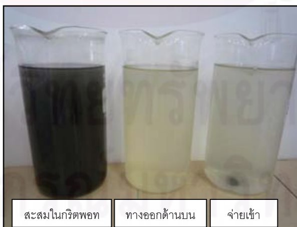
รูปที่ 4.20 แสดงลักษณะของตัวอย่างน้ำที่ได้จากการทดลองด้วยไฮโดรไซโคลนขนาดเส้นผ่านศูนย์กลาง 50 มิลลิเมตร ที่ติดตั้งกริตพอท ทั้ง 3 ช่องการไหล
