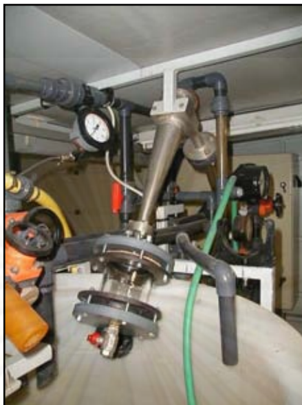
รูปที่ 3.4 ไฮโดรไซโคลนขนาดเส้นผ่านศูนย์กลาง 75 มิลลิเมตร ที่ติดตั้งกริตพอก
