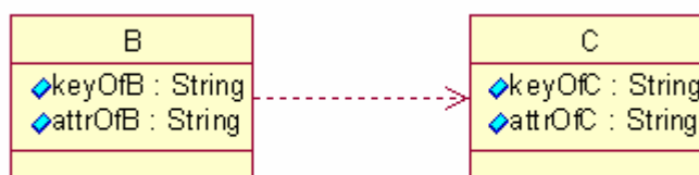
รูปที่ ก.6 แสดงคลาสไดอะแกรมที่มีความสัมพันธ์แบบดีเพนเดนซี
