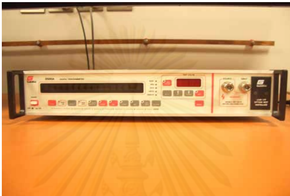
รูปที่ 4.16 Digital Teraohmmeter ยี่ห้อ Guildline รุ่น 6500A
