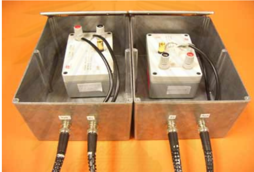
รูปที่ 4.12 วิธีการต่อตัวต้านทานไว้ในกล่องชีลด์ (shield)
