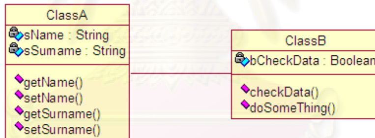
รูปที่ 22 ตัวอย่าง Class A กับ Class B ที่มีความสัมพันธ์แบบ Association
