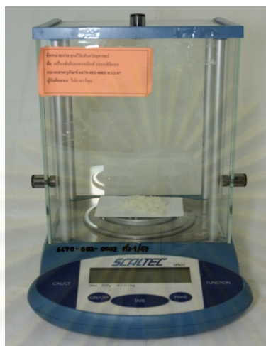
รูปที่ 13 เครื่องชั่งอิเล็กทรอนิกส์ ระบบดิจิทัล ความละเอียด 0.001 กรัม
