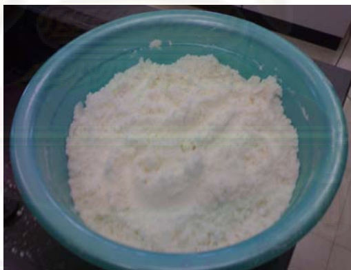
รูปที่ 3.5 เกลือผสมของโซเดียมไนเตรต โซเดียมไนไตรต์ และโพแทสเซียมไนเตรต
