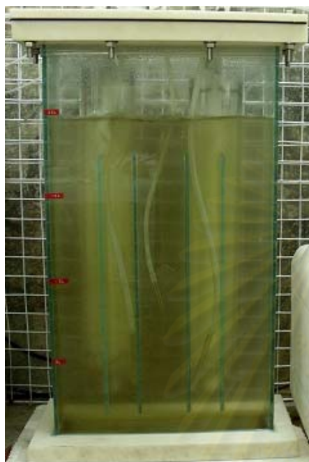
รูปที่ 3.9 ภาพถ่าย (ซ้าย) และแผนภาพ (ขวา) แสดงถึงปฏิกรณ์ชีวภาพเชิงแสงแบบแผ่นแบน ปริมาตรการทำงาน 20 ลิตร
