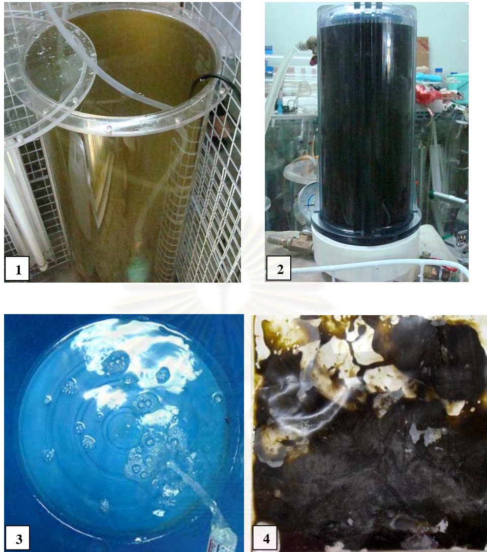
รูปที่ 4.21 ภาพถ่ายแสดงระบบการกรองเก็บเกี่ยวเซลล์ไคอะตอม Entomoneis sp. (1) ถังเก็บเกี่ยวเซลล์ขนาด 60 ลิตร (2) ระบบการกรองแบบแบ่งส่วน (3) ลักษณะสีของน้ำที่ผ่านการกรอง (4) ผลผลิตเซลล์ไคอะตอมที่ผ่านการกรอง
