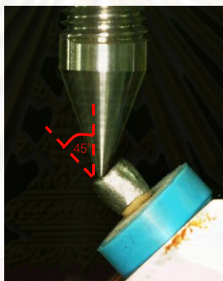
ภาพที่ 17 แสดงตำแหน่งการวางหัวกดที่ตำแหน่งกึ่งกลางพื้นเอียงด้านใกล้ลิ้นของปุ่มฟัน ด้านใกล้แก้ม โดยมีแนวแรงทำมุม 45^\circ กับแนวแกนฟัน
