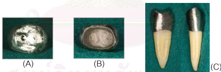
ภาพที่ 13 ครอบฟันโลหะเหรียญที่ใช้ในการทดลอง; (A) ด้านสบฟันของครอบฟันที่มีการเตรียมตำแหน่งรับหัวกดทดสอบ, (B) พื้นผิวด้านในของครอบฟันโลหะ, (C) ครอบฟันที่ยึดบนฟันหลักด้วยเรซินซีเมนต์วาริโอลิงค์ทู
