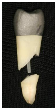
ภาพที่ 20 การแตกส่วนใหญ่ของกลุ่มที่ 1 เกิดขึ้นที่กึ่งกลางรากฟัน
