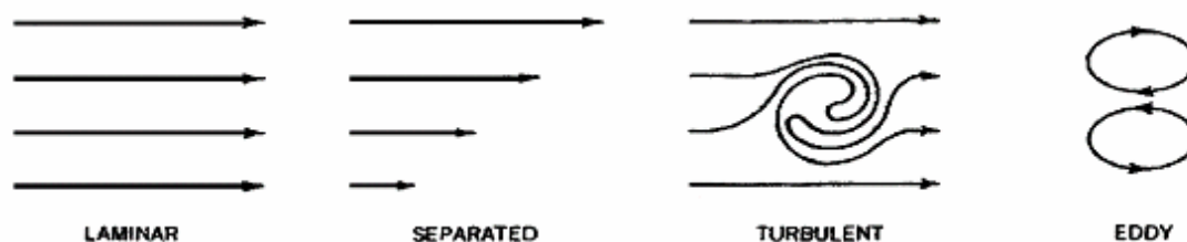
รูปที่ 2-10 ลักษณะการไหลของอากาศรูปแบบต่าง ๆ (Lechner, 1991: 184)
