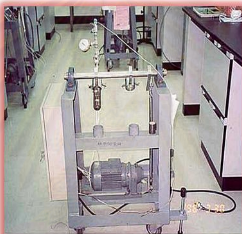
รูปที่ 3.2 ชุดอุปกรณ์ควบคุมแบบดิจิทัลและชุดควบคุมเครื่องปฏิกรณ์
