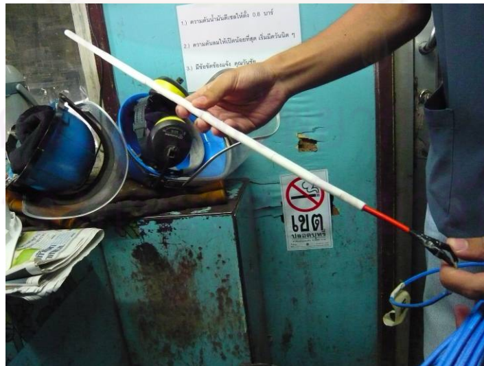
รูปที่ 4.3 เทอร์โมคัปเปิลชนิด K แบบตะเกียบ
