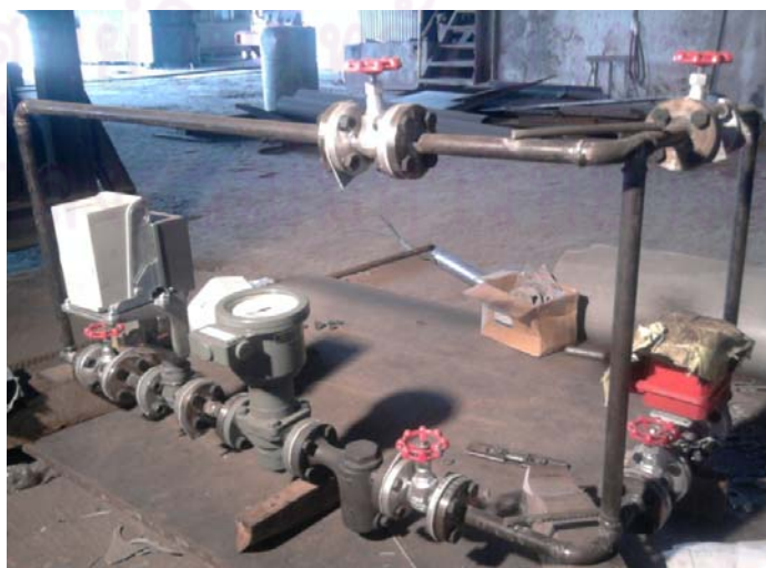
รูปที่ 4.14 ชุดท่อน้ำมันของหัวเผาแบบรีเจนเนอเรทีฟ
