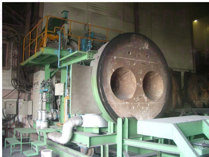
รูปที่ 4.17 หัวเผาแบบรีเจนเนอเรทีฟที่ติดตั้งเรียบร้อยแล้ว
