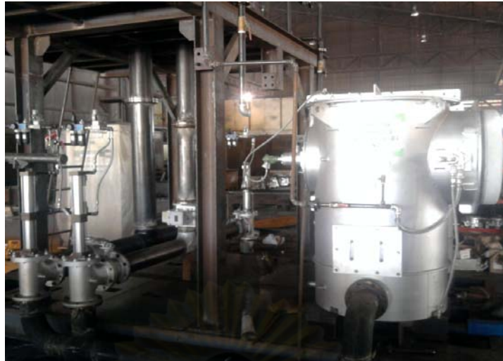
รูปที่ 4.12 หัวเผาแบบรีเจนเนอเรทีฟรุ่น RCB-FH20
