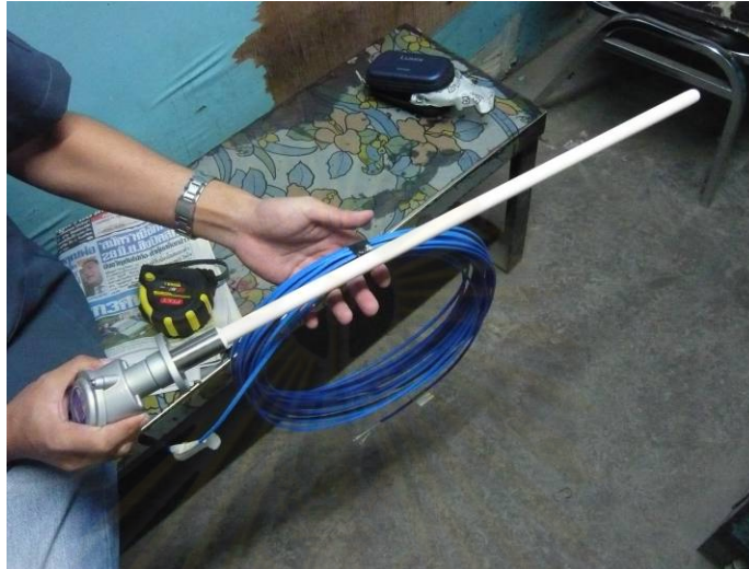
รูปที่ 4.2 เทอร์โมคัปเปิลชนิด K แบบเซรามิก
