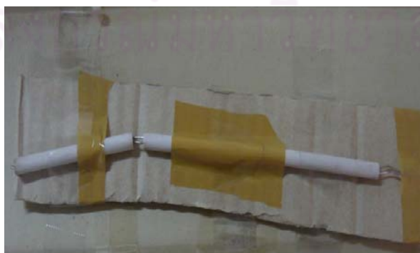
รูปที่ 4.1 ลวดเทอร์โมคัปเปิลชนิด R
