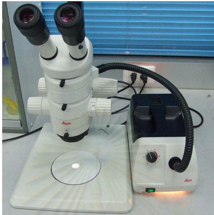
ภาพที่ 8 กล้องจุลทรรศน์ LEICA รุ่น MS5 สำหรับใช้เตรียมสไลด์ตัวอย่าง
