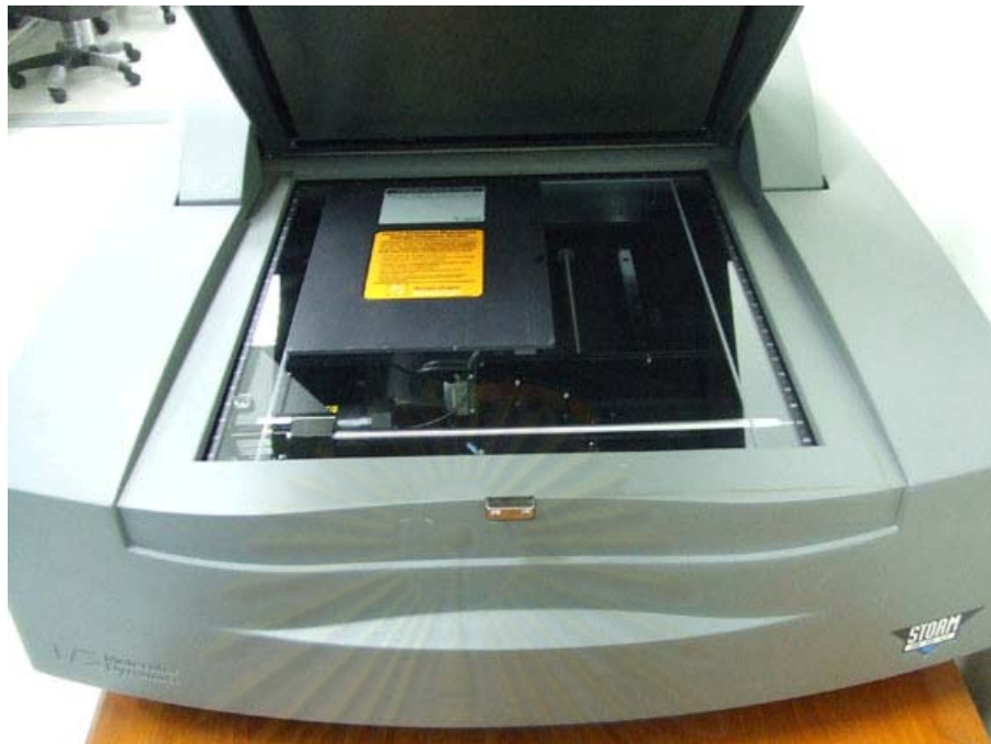
ภาพที่ 6 เครื่องอ่านอิมเมจเพลต STORM รุ่น 820
