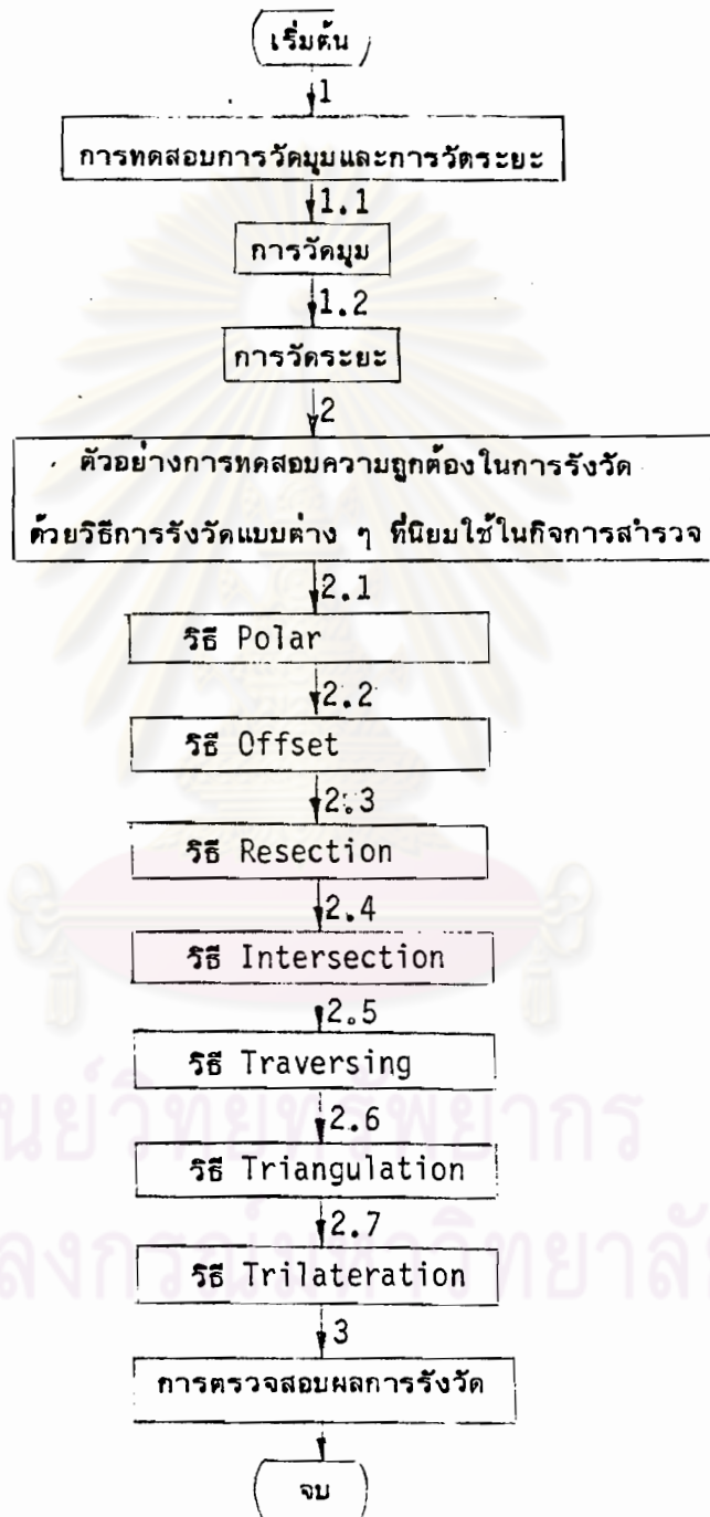
รูปที่ 6.1 ลำดับขั้นตอนการทดสอบการรังวัดในสนามทดสอบ
