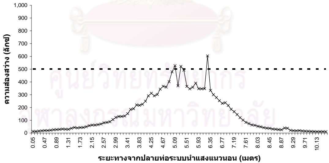
รูปภาพ 4 ปริมาณและลักษณะการกระจายแสงบนระนาบพื้นที่ทำงานของระบบท่อนำแสงแนวนอนรูปแบบที่ 4 ที่รับแสงธรรมชาติจากทิศใต้ เมื่อเปรียบเทียบกับข้อเสนอแนะของ TIEA
