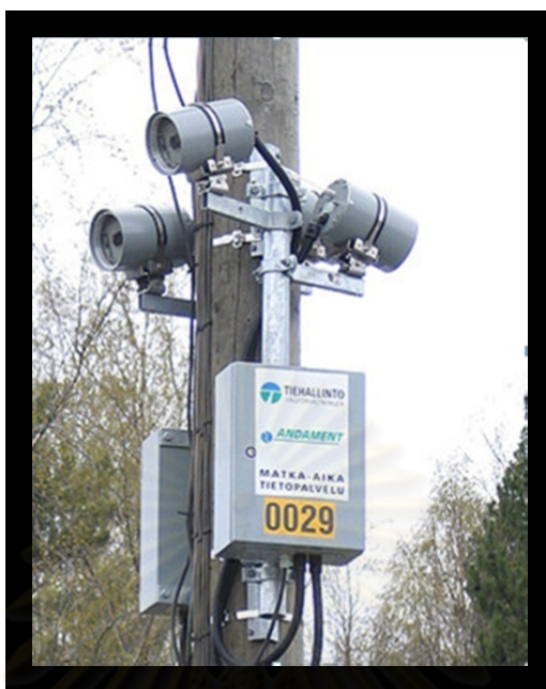
รูปที่ 2.2 ชุดอุปกรณ์เก็บข้อมูลเวลาการเดินทาง ที่มา: Pasi Halttunen และ Reijo Prokkola (2008)
