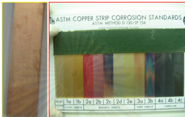
รูปที่ 4.8 ค่ากัดกร่อนของน้ำมันชีวภาพจากฟางข้าว ตามมาตรฐาน ASTM D130/IP 154
