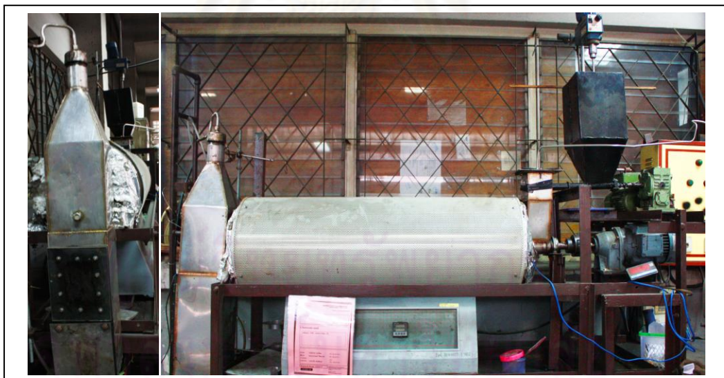
รูปที่ 3.3 ชุดเครื่องปฏิกรณ์แบบต่อเนื่อง
