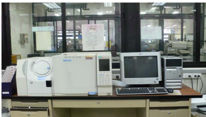
รูปที่ 3.7 เครื่องแก๊สโครมาโทกราฟีกับแมสสเปกโตรมิเตอร์ (Gas Chromatograph with Mass Spectrometer, GC-MS)
