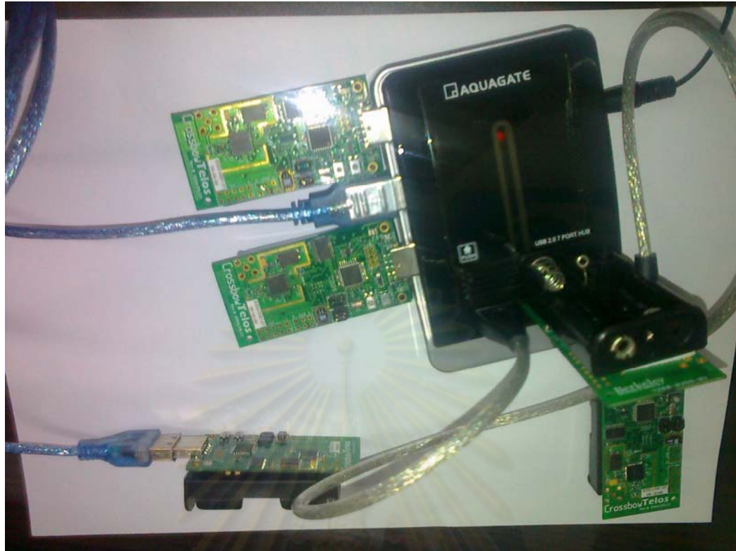
ภาพที่ 4.3 อุปกรณ์ตัวรับรู้อย่างไรสายรุ่น Telosb หลายตัวบนยูเอสบีซี
