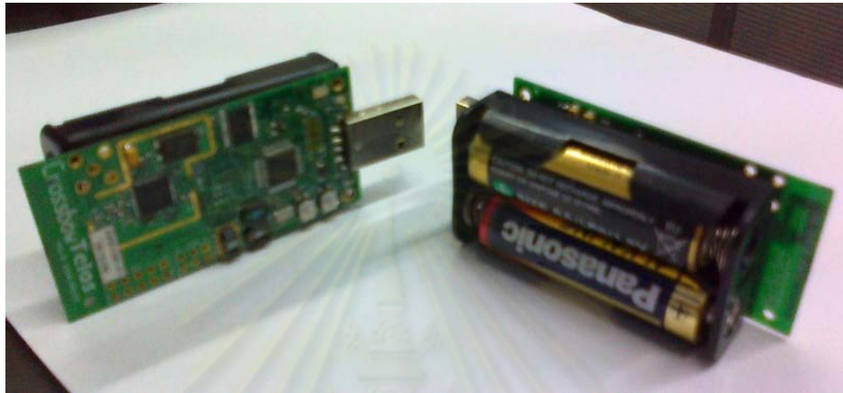
ภาพที่ 4.1 อุปกรณ์ตัวรับรู้แบบไร้สายรุ่น Telosb
