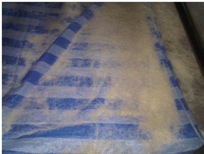
ภาพที่ 4.14 ภาพของเสียจากเส้นไหมที่รอบเกินไป
