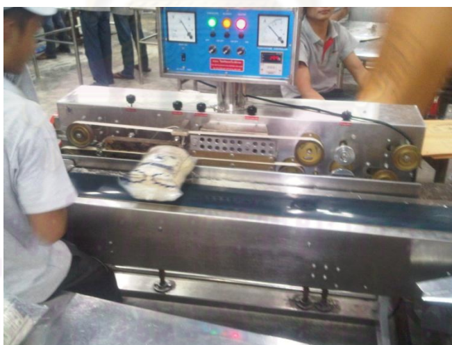
ภาพที่ 5.2 ภาพเครื่องซีลแบบใหม่ที่ทำการเปลี่ยน
