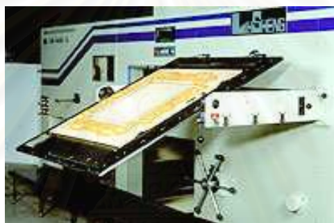
รูปที่ 3.14 เครื่องปั๊มคัทหรือไดคัท (Diecut Machine)
