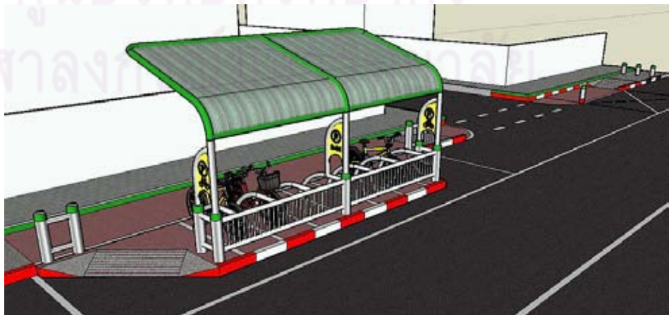
รูป 7.50 ที่จอดจักรยานแบบมีหลังคา พร้อมราวปลอดภัยสูง
