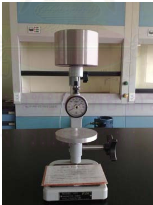
รูปที่ ง2 เครื่อง Hardness testing machine รุ่น PTC model 402
