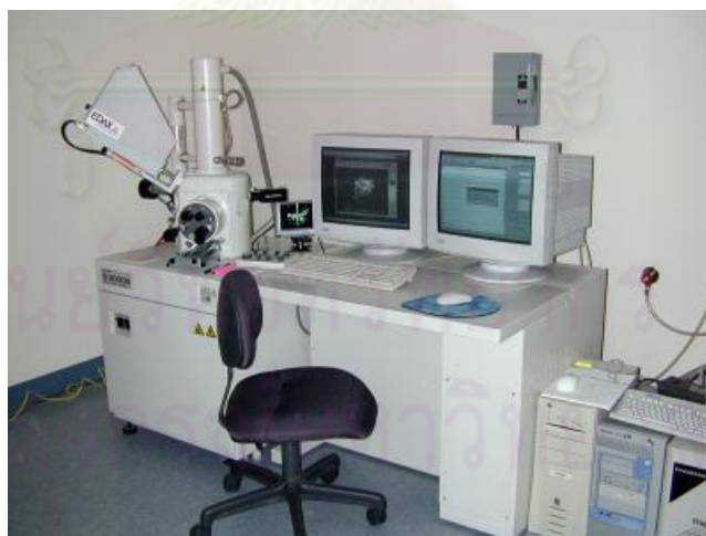
รูปที่ ๓4 เครื่อง Scanning Electron Microscope (SEM) JSM-35CF
