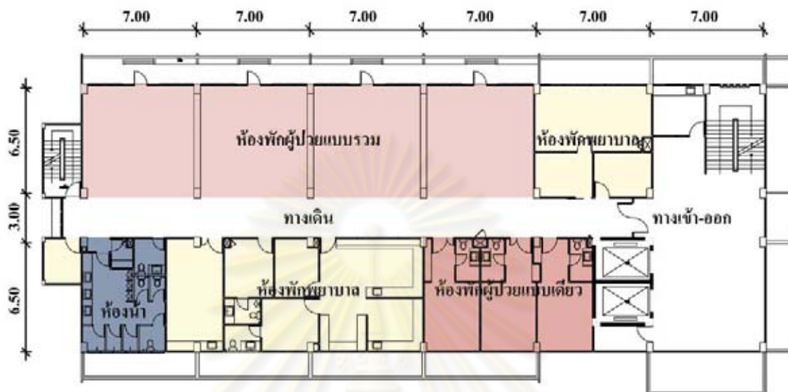
ภาพที่ 2.26 แสดงตัวอย่างรูปแบบการวางผังพื้นของหอผู้ป่วยโรงพยาบาล
