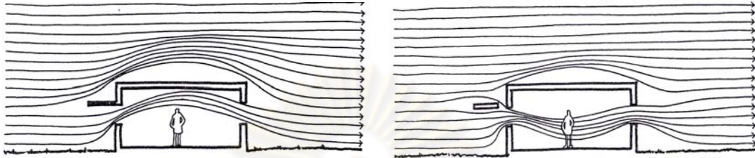
ภาพที่ 2.23 แสดงทิศทางการไหลของอากาศเปรียบเทียบลักษณะกันสาดแบบต่างๆ : รูปตัด (ที่มา: passive cooling : ventilation ,fuller moore,1993:184.)
