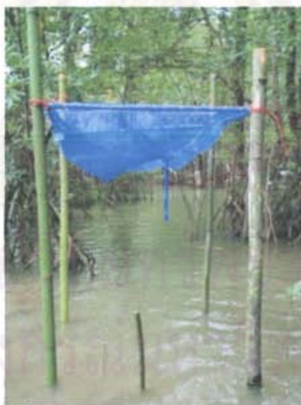
ภาพที่ 3.4 กระบะรองรับซากพืชที่มีพื้นที่หน้าตัดขนาด 1x1 ตารางเมตร โครงของกระบะรองรับซากพืชทำจากท่อ PVC และมีตาข่ายไนลอนรองรับซากพืชที่ร่วงหล่น โครงของกระบะนี้จะถูกผูกติดกับเสาหลักไม้ไผ่ให้อยู่สูงกว่าระดับน้ำทะเลที่ขึ้นสูงที่สุด
