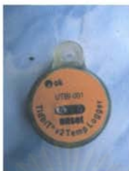
ภาพที่ 3.1 Temperature sensors และ Data loggers (TidbiT v2 Temp logger, Onset Computer Co., Ltd.; สำหรับบันทึกอุณหภูมิ
