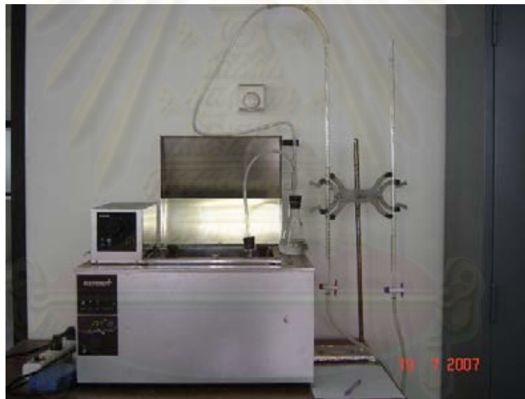
รูปที่ ง.1 อุปกรณ์ที่ใช้หาค่าความสามารถจำเพาะของแบคทีเรียสร้างมีเทน(Specific Methanogenic Activity; SMA)
