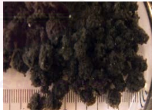
pulp powder 800 มก./กรัม เอสเอส + polymer 2 มก./กรัม เอสเอส
