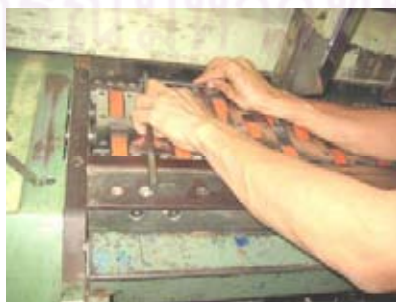
รูปที่ 4.25 วิธีการวัดระยะห่างระหว่าง Plate table กับ พื้นโต๊ะป้อนกระดาษ
