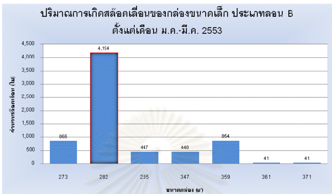
รูปที่ 4.2 ปริมาณการเกิดสล็อตเลื่อนของกล่องขนาดเล็ก ประเภทลอน B
