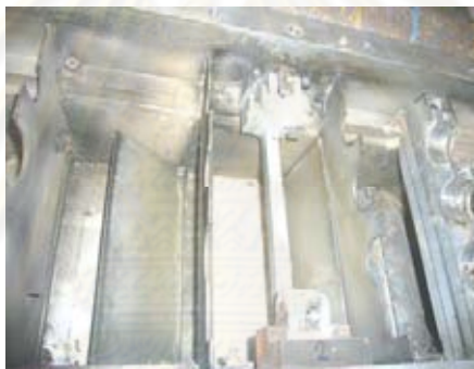
รูปที่ 5.1 ชุดของกลไกการเคลื่อนที่ขึ้นลงของ Plate table
