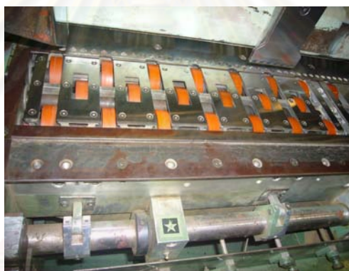
(3) ประกอบ Feed wheel เข้ากับ Plate table
