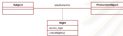
รูปที่ 5 แผนภาพคลาสของแบบรูปการให้อำนาจที่เป็นต้นแบบ
