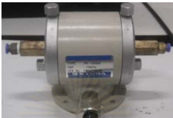
ภาพที่ 3.6 มาตรฐานวัดการเปลี่ยนแปลงปริมาตรน้ำ (Volumetric transducer)
