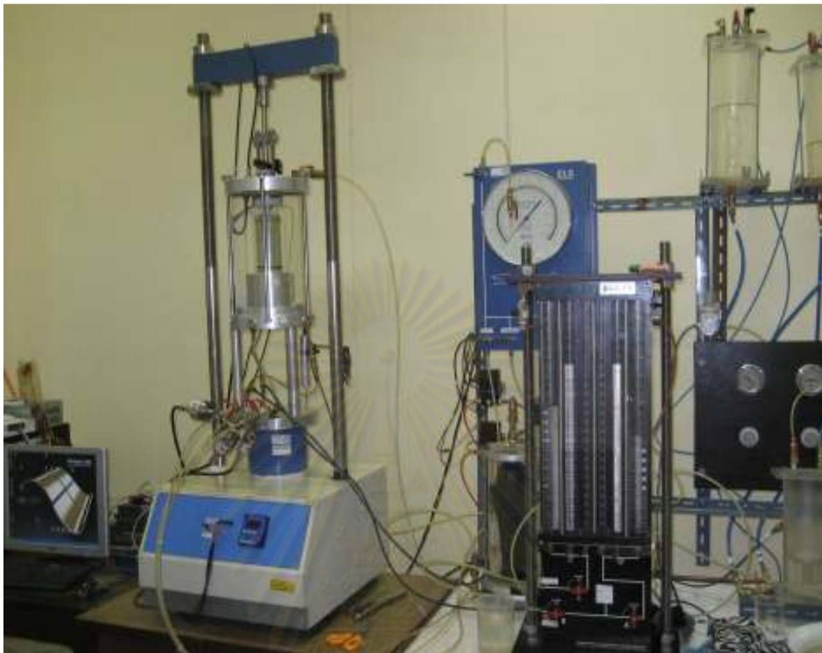
ภาพที่ 3.15 เครื่องทดสอบสามแกนที่พัฒนาขึ้น
