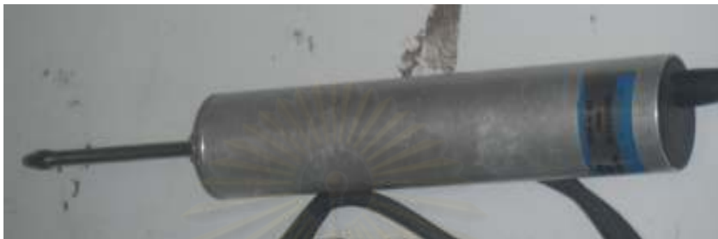
ภาพที่ 3.4 อุปกรณ์วัดการเคลื่อนตัวในแนวแกน (LVDT)
