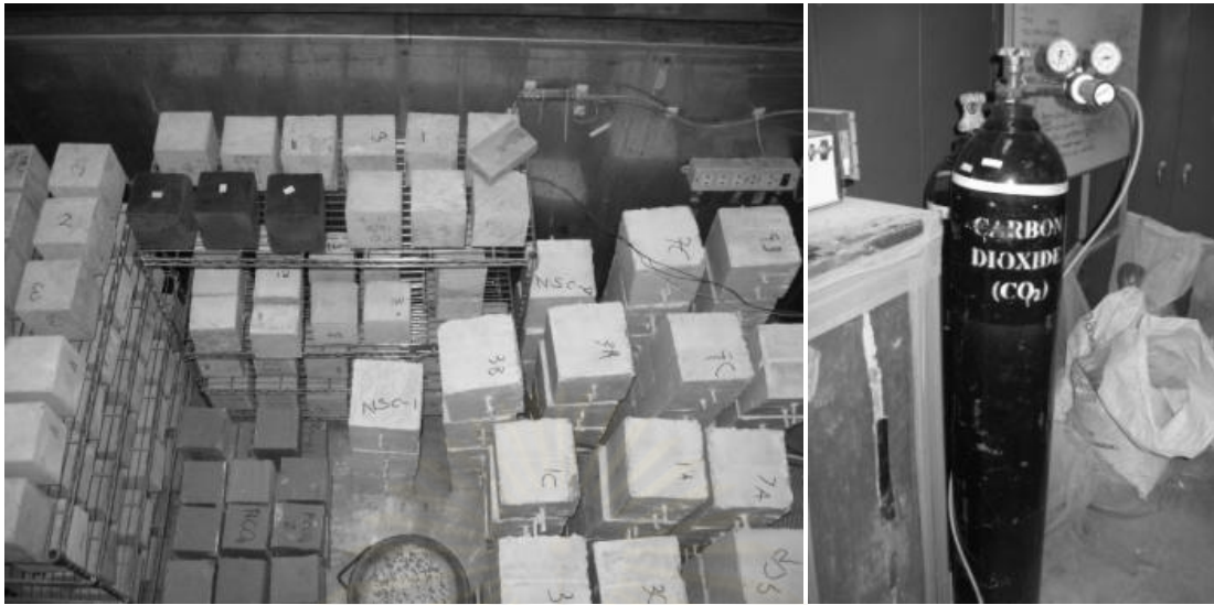
ภาพที่ 4.17 ตู้ทดสอบคาร์บอนไดออกไซด์ที่สภาวะเร่ง
