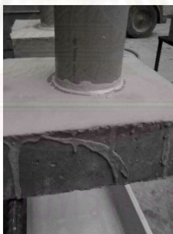
ภาพที่ 4.10 การติดตั้งท่อน้ำเข้ากับชิ้นตัวอย่างด้วยอีพอกซี
