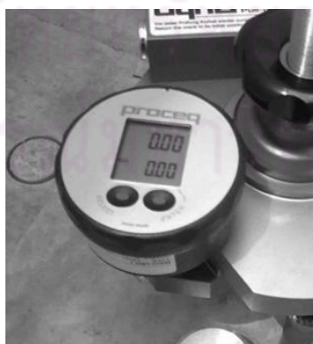
ภาพที่ 4.4 การตั้งค่าเริ่มต้นเครื่องทดสอบกำลังยึดเกาะ
