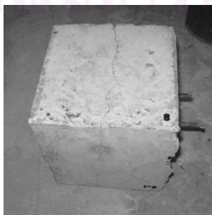
ภาพที่ 4.13 ตัวอย่างที่มีรอยร้าวในการทดสอบความต้านทานคาร์บอนเนชั่น
