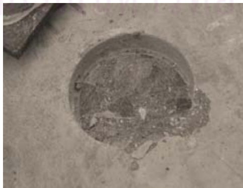
ภาพที่ 5.2 การวิบัติของคอนกรีตเมื่อทดสอบกำลังยัดเกาะตามมาตรฐาน ASTM C1583
