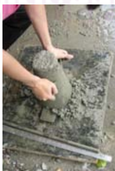
ภาพที่ 3.2 การทดสอบค่าการยุบตัวของคอนกรีตในการวิจัย
