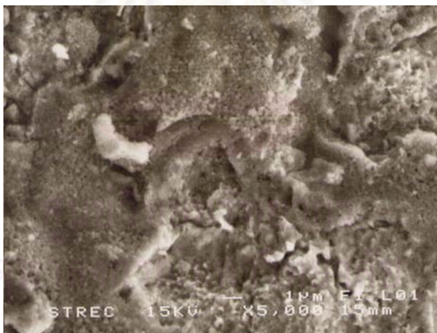
รูปที่ จ-10 ลักษณะผิวเหล็กกล้าไร้สนิม AISI 304 ที่ผ่านการอบอ่อนอุณหภูมิ 1100°ซ เวลา 90 วินาที และออกซิเจนร้อยละ 7.08
