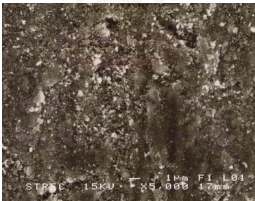
รูปที่ จ-4 ลักษณะผิวเหล็กกล้าไร้สนิม AISI 304 ที่ผ่านการอบอ่อนอุณหภูมิ 1000°ซ เวลา 90 วินาที และออกซิเจนร้อยละ 7.08
