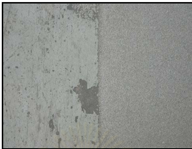
รูปที่ 2.8 ผิวเหล็กกล้าไร้สนิม AISI 304 ก่อน (ก) และหลัง (ข) การกำจัดสเกลออกไซด์ด้วยเม็ดเหล็ก (Shot blasting) [17]
