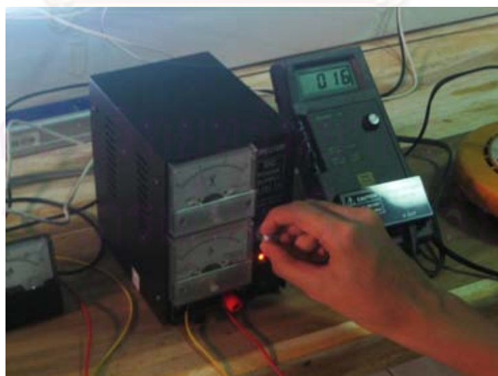
ภาพที่ 3.22 แสดงการปรับระดับความสว่างด้วยเครื่องผลิต DC Volt
