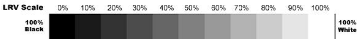
ภาพที่ 2.11 แสดงช่วงการสะท้อนตามมาตรฐานของ LRV
