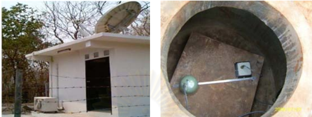
ภาพที่ 3.5 สถานีตรวจวัดแผ่นดินไหวเขื่อนศรีนครินทร์
