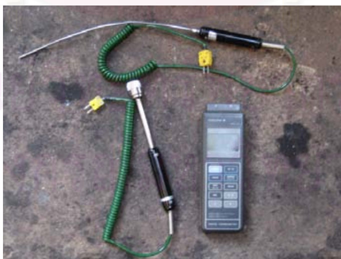
รูปที่ 4.4 Thermocouple หัวแบบ contact และ immersion
