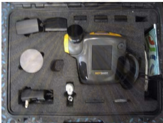
รูปที่ 4.7 Thermal imaging camera
