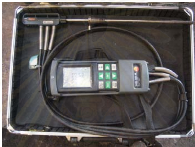
รูปที่ 4.5 Flue gas analyzer
