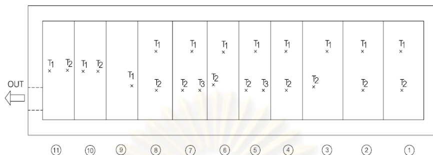
รูปที่ ค.6 ภาพแสดงตำแหน่งการวัดอุณหภูมิผิวผนังด้านหน้าเตาเผาเหล็ก บ. อุตสาหกรรมเหล็กกล้าไทย จำกัด (มหาชน) โดยใช้ thermocouple ช่วงวัดเหล็ก
