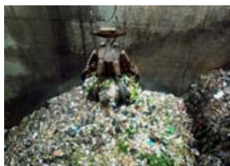
บ่อพักมูลฝอยและบ้นจั่นคืบมูล
