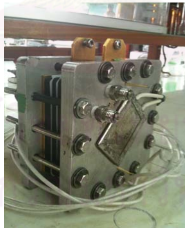
รูปที่ 3.8 Hardware สำหรับทดสอบสมรรถนะของเซลล์เชื้อเพลิง (ชั้นเซลล์เชื้อเพลิง)
