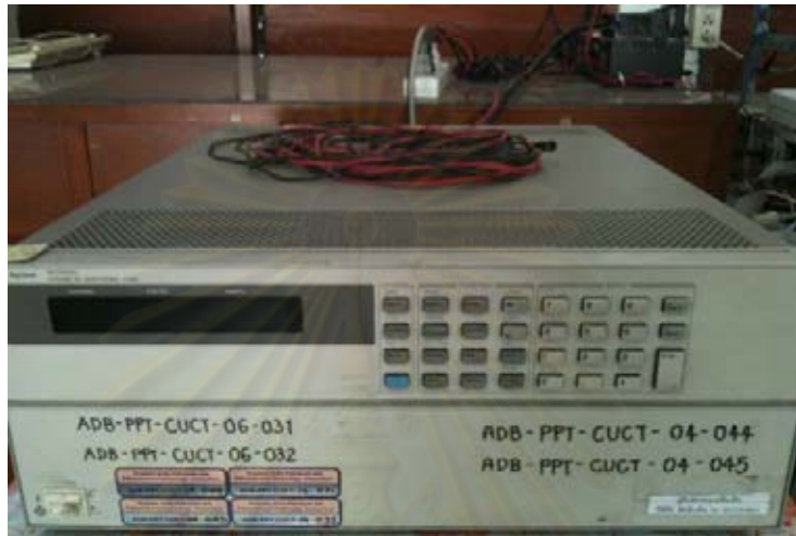
รูปที่ 3.7 เครื่อง Electronic load รุ่น N3300A บริษัท Agilent
