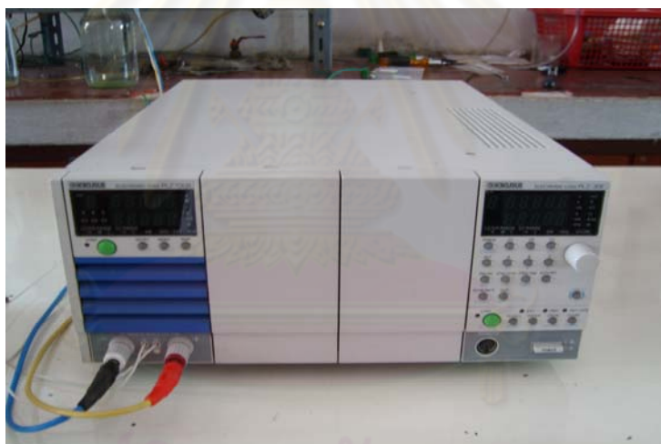
รูปที่ 3.6 เครื่อง Electronic load รุ่น PLZ-30F บริษัท KIKUISUI
