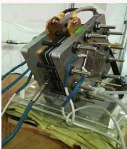
รูปที่ 3.10 ลักษณะของการวางชั้นเซลล์เชื้อเพลิงเอียงเป็นมุม 30 องศาของหน่วยทดสอบ
