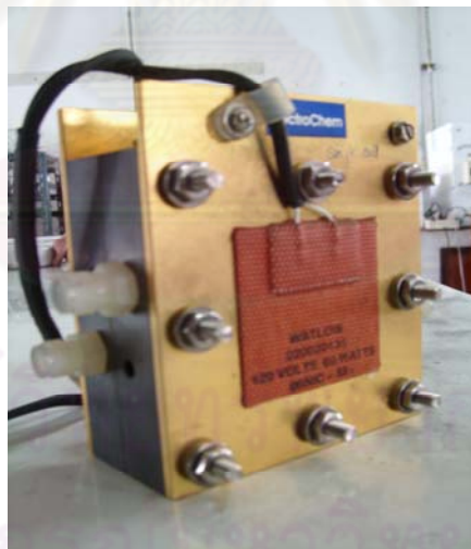
รูปที่ 3.1 ระบบทดสอบสมรรถนะของเซลล์เชื้อเพลิงสำหรับเซลล์เดี่ยวที่ใช้ในการทดลอง
