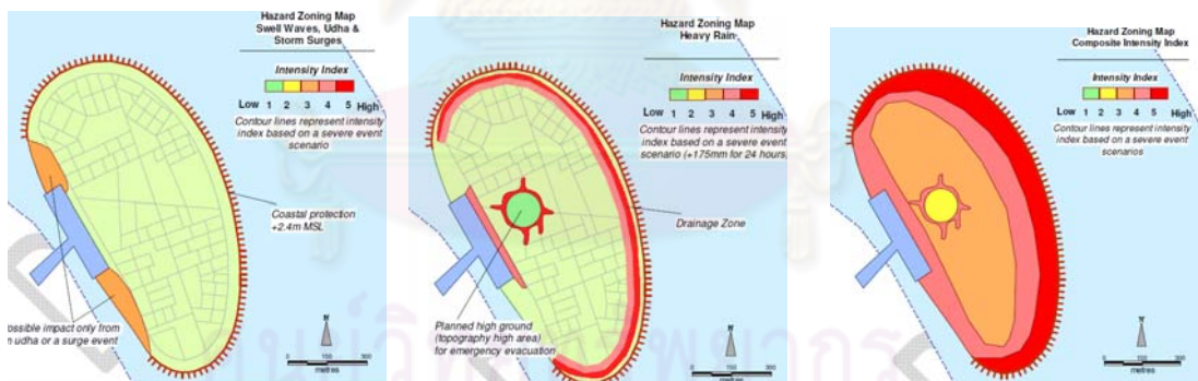
ภาพที่ 2-12 ตัวอย่างการกำหนดพื้นที่เสี่ยงภัยน้ำท่วมของเกาะมัลดีฟ เป็นการกำหนดผังแม่บทการใช้ประโยชน์ที่ดิน และอาคารในพื้นที่เสี่ยงภัยน้ำท่วมเหมาะกับวางแผน หรือผังในอนาคต และเหมาะสมสำหรับพื้นที่ที่มีรูปแบบการใช้พื้นที่ที่หลากหลายประเภท หรือมีลำดับความสำคัญของแต่ละส่วนที่ต่างกัน
