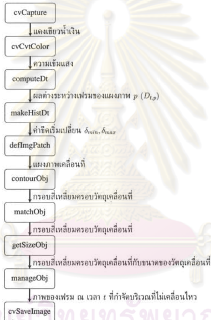
รูปที่ 3.2 การไหลข้อมูลการตรวจหาวัตถุเคลื่อนที่ในลำดับภาพวิดีโอที่สนโดยใช้ระบบฝังตัว
